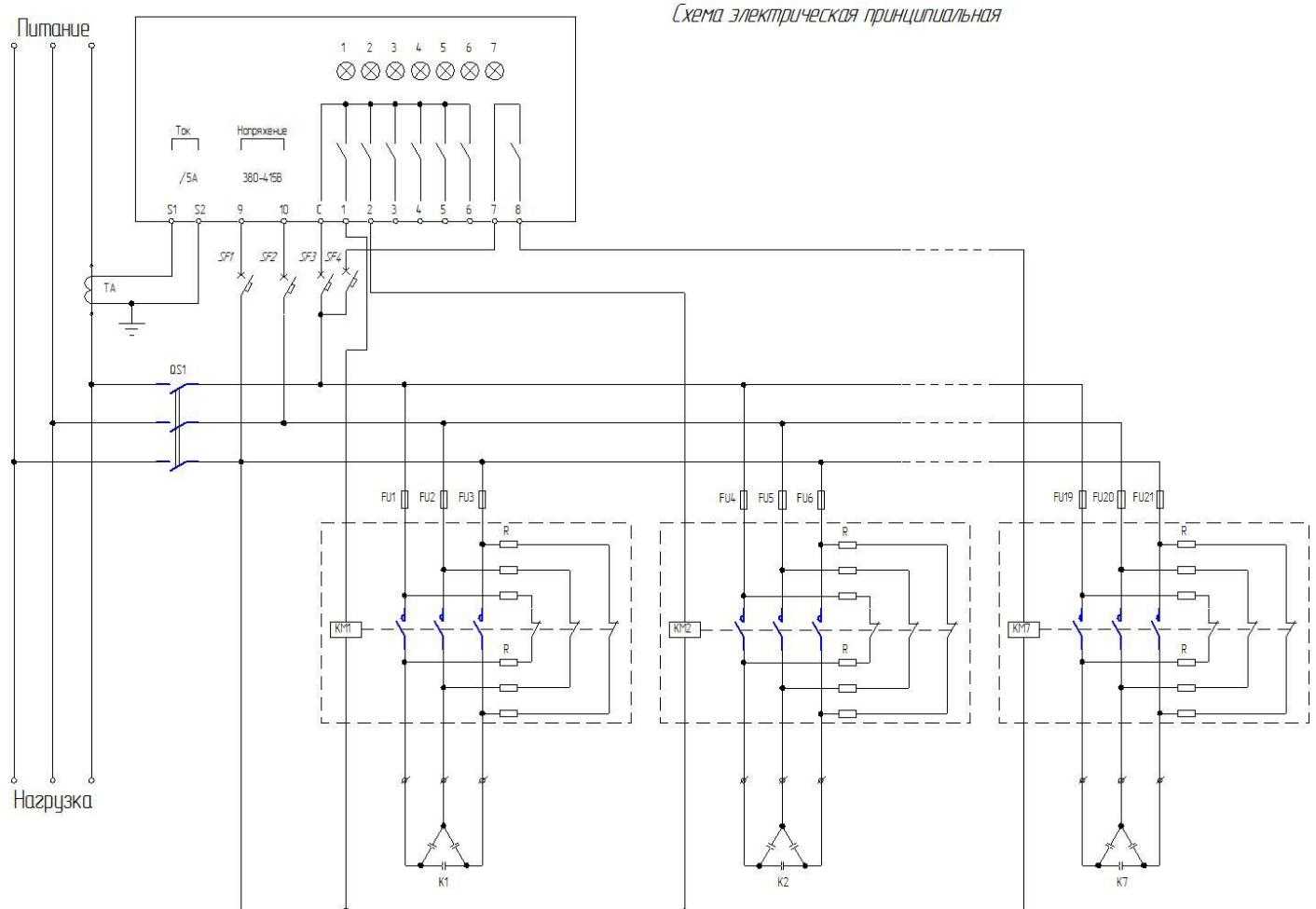
Электрическая принципиальная схема может отличаться от приведённой в данном руководстве в зависимости от примененного регулятора реактивной мощности (см. инструкцию на регулятор). В качестве примера приведена схема принципиальная схема подключений семи ступенчатой конденсаторной установки, приведенный на схеме трансформатор тока ТА в комплект поставки не входит, устанавливается заказчиком исходя из параметров электрической сети (см. инструкцию на регулятор)
