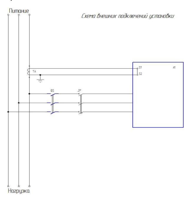
**ТА**-Трансформатор тока технического учета эл. энергии со стороны 0,4 кВ. Выбор контролируемой фазы (см. инструкцию на регулятор)
