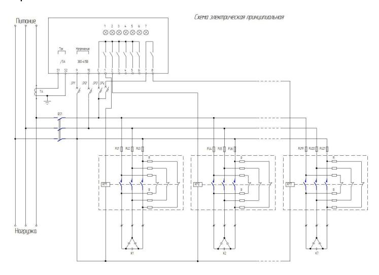
Электрическая принципиальная схема может отличаться от приведённой в данном руководстве в зависимости от примененного регулятора реактивной мощности (см. инструкцию на регулятор). В качестве примера приведена схема принципиальная схема подключений семи ступенчатой конденсаторной установки, приведенный на схеме трансформатор тока ТА в комплект поставки не входит, устанавливается заказчиком исходя из параметров электрической сети (см. инструкцию на регулятор)
